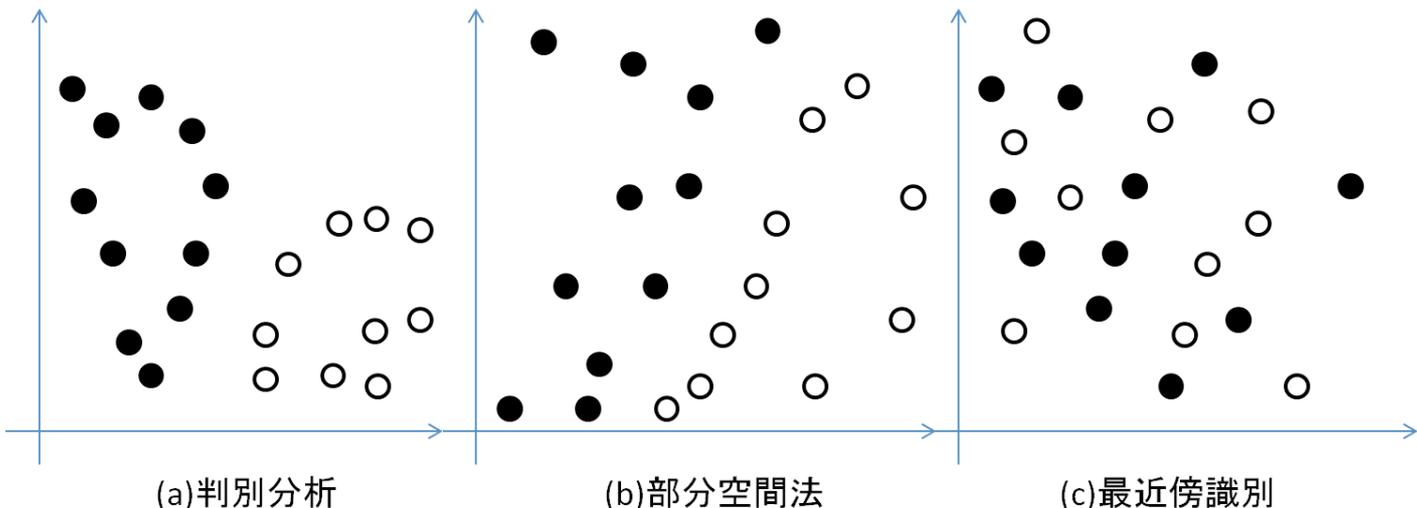
理由：(b) の特徴分布にそのまま部分空間法を適用するのは適切ではない。これは、識別境界が原点を通過しないため、自己相関行列の固有値分解で得られる基底群の張る部分空間への射影をしても、原点付近のデータは正しき識別できないためである。判別分析や SVM, 最近傍識別, 正規分布の当てはめによる統計的識別などを用いるべきである。
