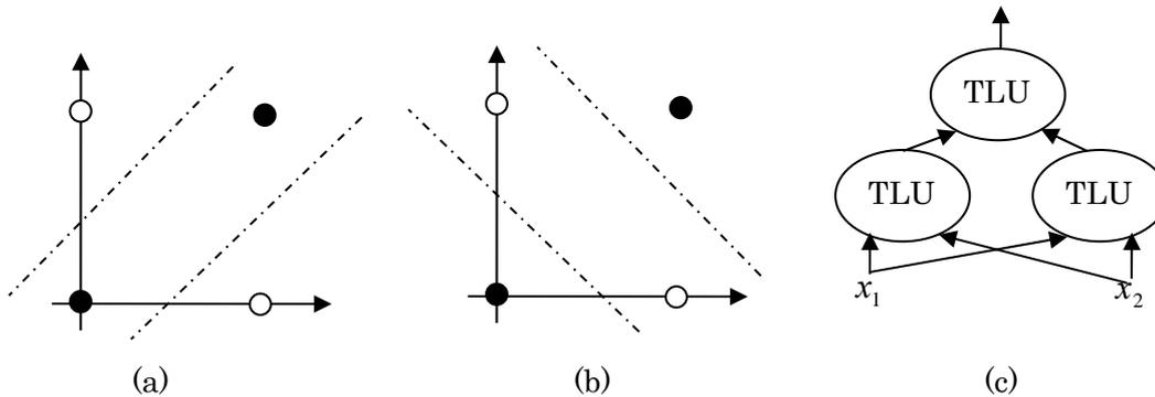
上図(a)(b)のように、二入力 Exclusive OR は(0,0)と(1,1)で 0(●で表示)、(0,1)と(1,0)で 1 (○で表示)となる。TLU は線形識別面の学習を行う機構であるので、0 と 1 の間に境界となる線形識別面を入れると、上図一点鎖線で表示したように、一つの線形識別面で境界を表現することはできない。少なくとも 2 つの TLU が必要になる。上図(a)(b)のどちらのケースでも、線形識別面によって区切られるどちらの半空間にパターンが属するのかを判定する TLU が二つ必要であり、それら 2 つの TLU の出力を総合して、出力として 1 を出すか否かを決定する TLU が最終的な出力層に必要となる。但し上図(c)では各 TLU の-1 に固定された入力省略している。
